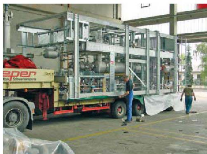
二级蒸馏设备KD400/KD400的整机装车运输
